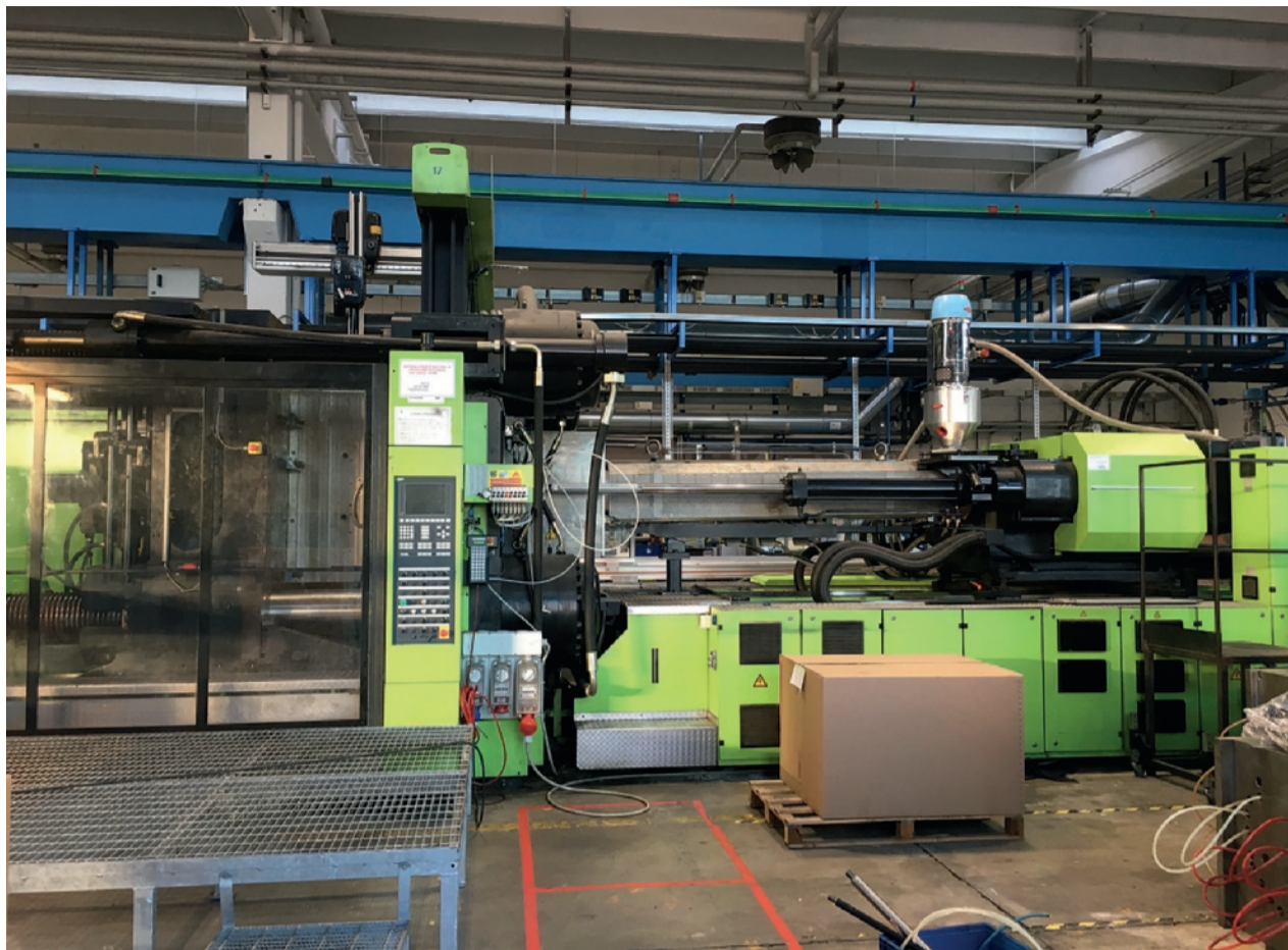
Una delle presse di maggiore tonnellaggio presenti nel reparto stampaggio.
